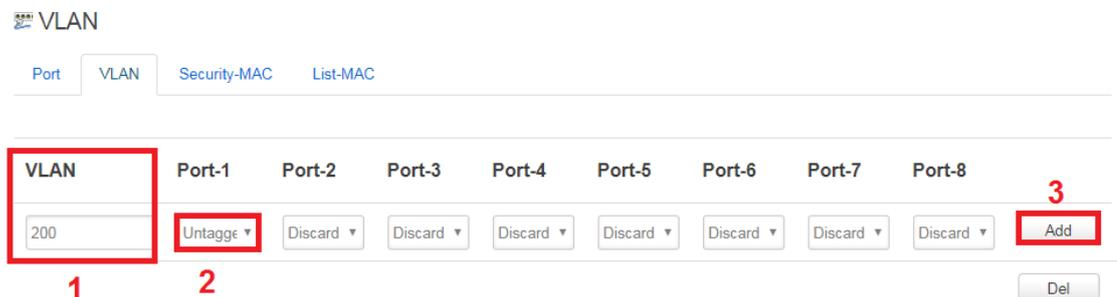
Figura 4: Retirando TAG Vlan na porta 1 do Pac-Gpon.
