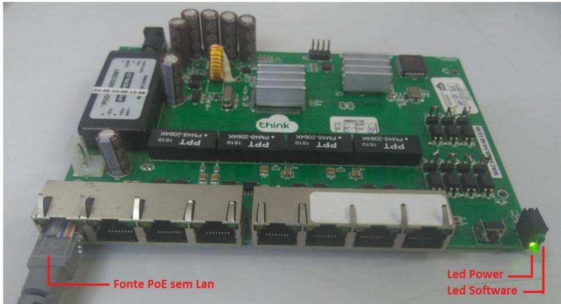
**Figura 1- Comportamento dos Leds da placa.**
