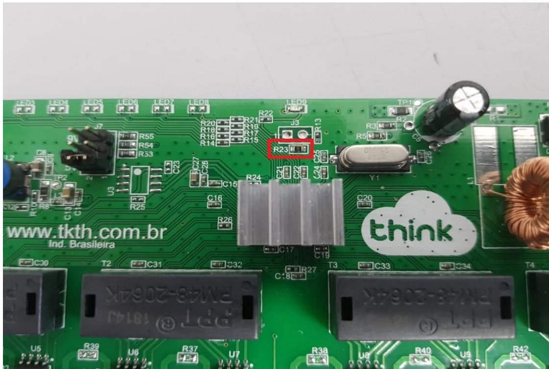
Figura 9-Retirada do resistor R23.
