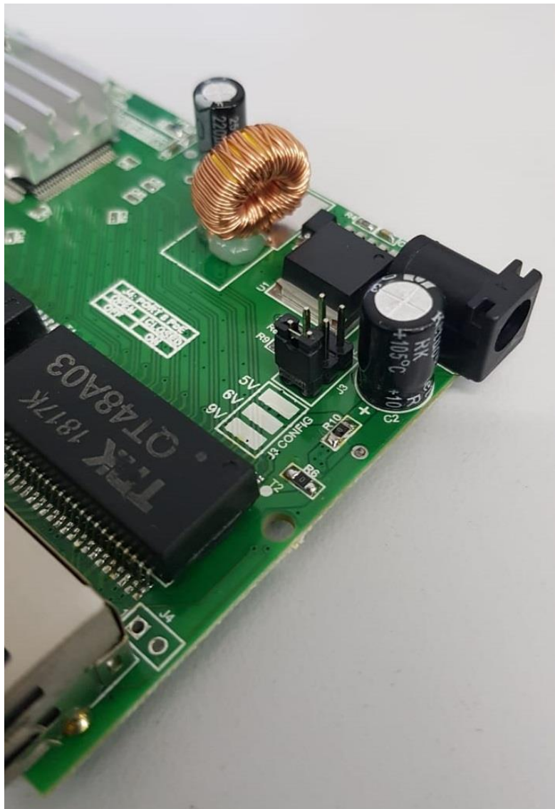
Figura 6-Exemplo de configuração de tensão em 9 VDC – Posição abaixo.
