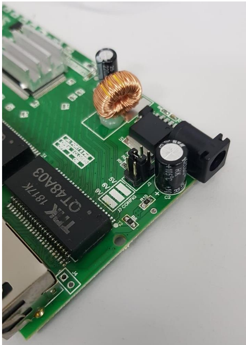
Figura 7- Exemplo de configuração de tensão em 6 VDC – Posição central.
