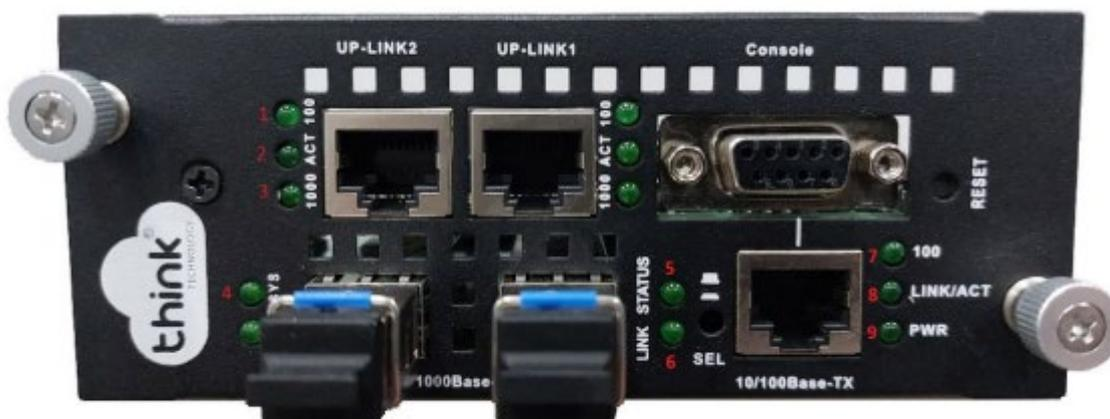
1. 100: velocidade de conexão 100 Mbps na porta de Uplink;
