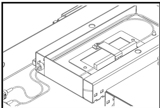
Após travar o corpo do splitter na bandeja faça a acomodação da reserva, com uma cinta de nylon trave os cordões do splitter utilizando as furações laterais conforme a imagem abaixo (a cinta deve somente segurar a fibra, não apertar muito forte).
