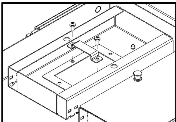
Com uma Chave Philips, remova a abraçadeira metálica para acomodação dos splitter's.
